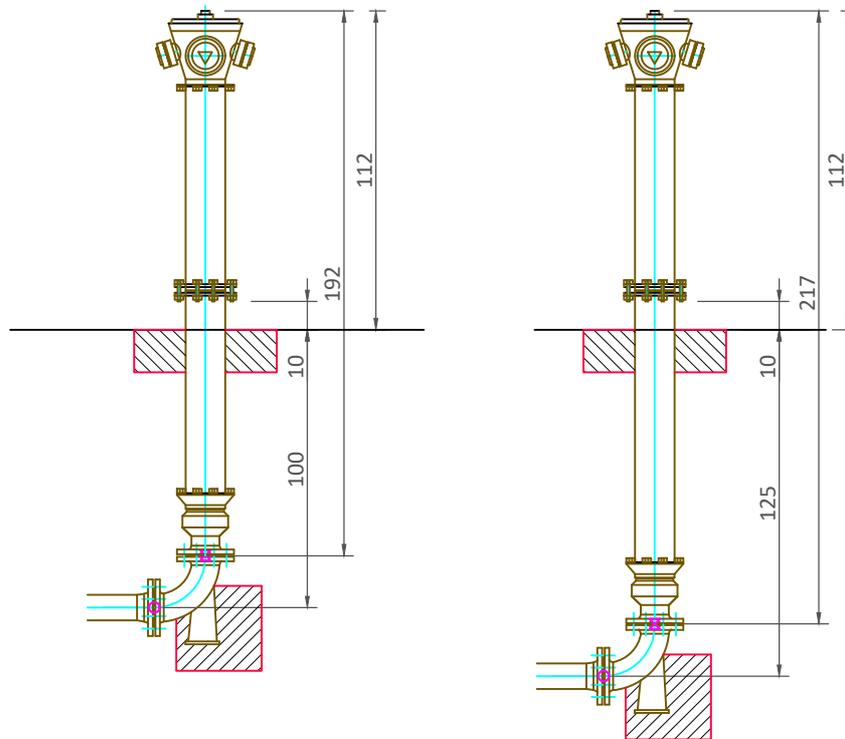
Če so hidranti montirani v zemljini je potrebno izdelati ploščo dim. 50x50x15 cm oz. jih ustrezno obbetonirati.
