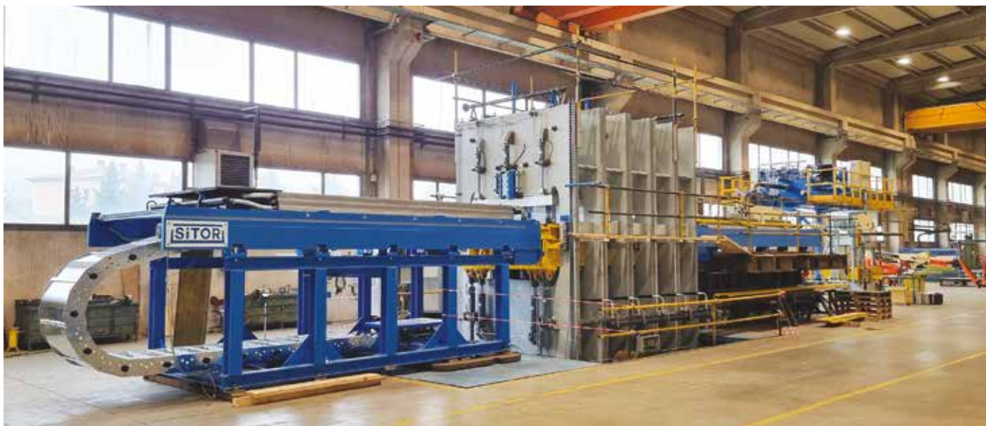
Hidravlična stiskalnica za izdelavo plastičnih plošč
